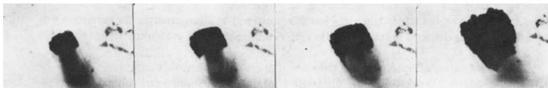
Fig. 3. Croissance d'un grain d'argent à la surface d'une plaque monocristalline [001] de chlorure d'argent
